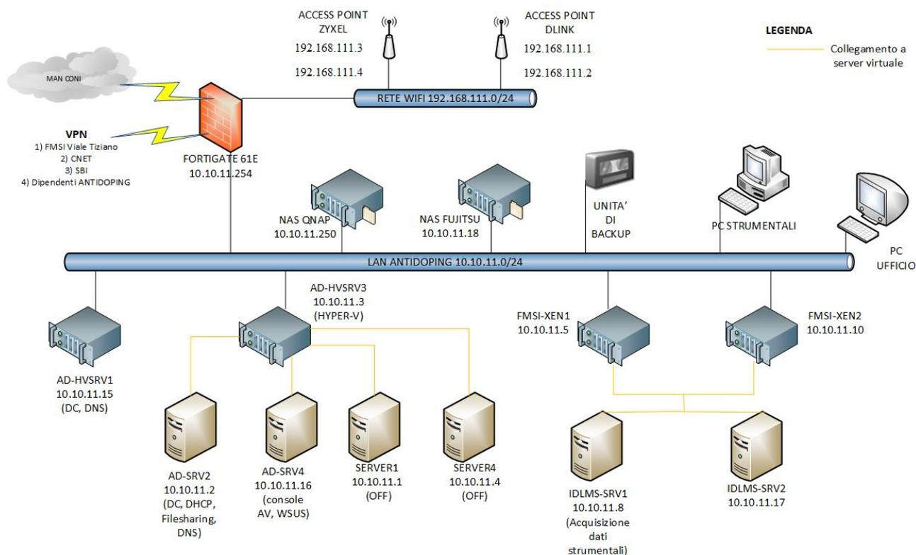
Al riguardo occorre segnalare la peculiarità della rete del Laboratorio Antidoping FMSI, che si configura come una Rete LAN “inglobata” nella più ampia Rete MAN del CONI, con la conseguente complessità della gestione dei flussi dei dati sia in uscita sia in entrata.
